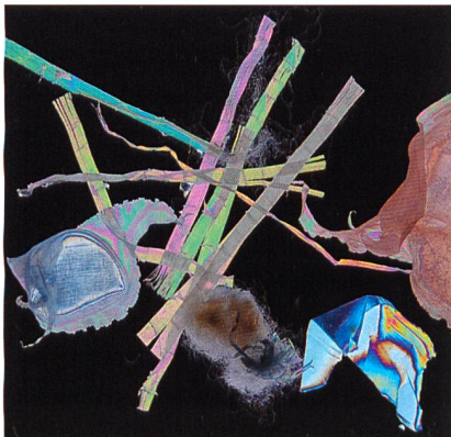
Abb. 2: Fremtteile im polarisierten Licht
