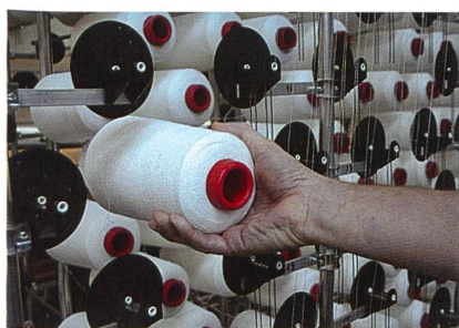
Abb. 4: Spulenwechsel am optimierten Gatter
