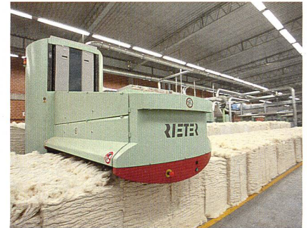
Abb. 2: Der automatische Ballenöffner UNIfloc A 11 erzeugt kleine Flocken zu Beginn des Prozesses
