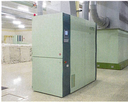
Abb. 3: Der Vorreiniger UNClean B 12 ist die effiziente Reinigungs- und Entstaubungsmaschine, die direkt nach der Ballenabtragung eingesetzt wird
