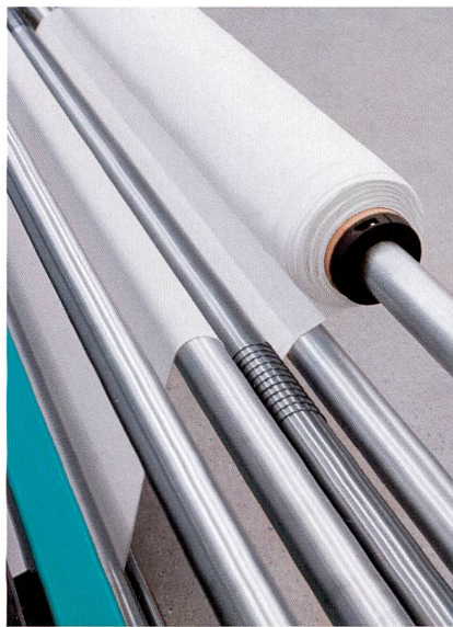
Abb. 3: Die Ausstreichvorrichtung mit dem Spiralfeder-Profil zum Breitstreichen der Ware
