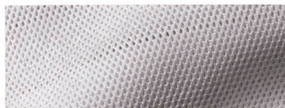
Abb. 1: Zweiseiten-Musterung aus einer Filetstruktur
