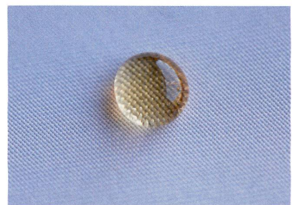
Abb. 2: Nano-funktionalisierte Textilien weisen Wasser und Schmutz ab
