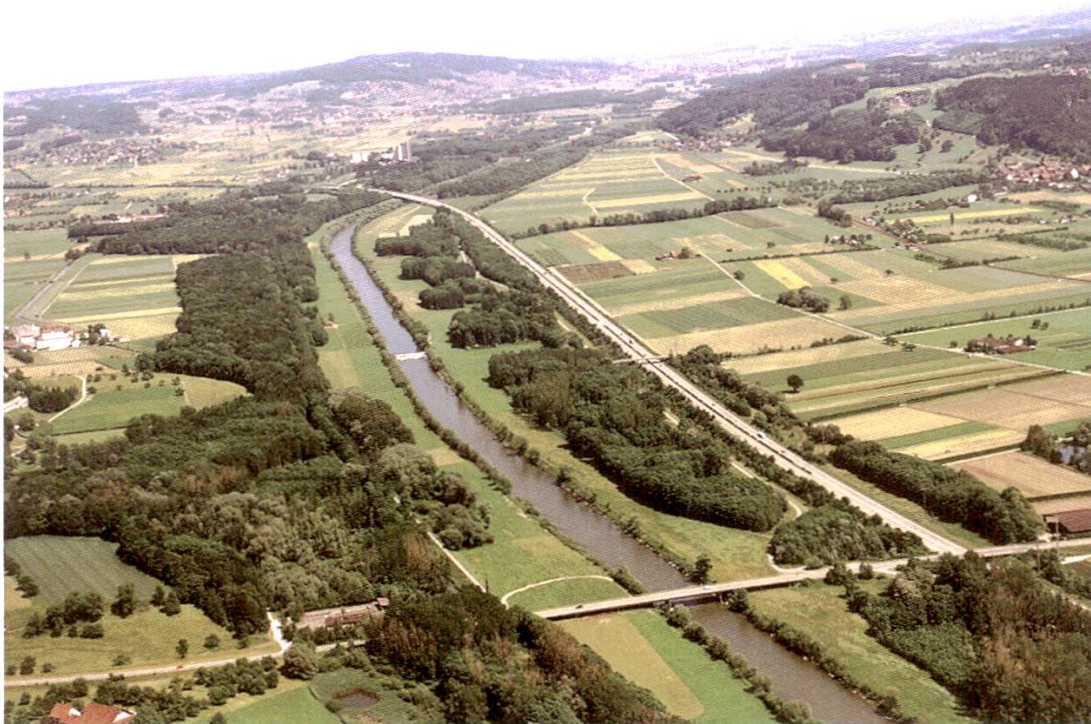
Abbildung 3: Heutiger Thurlauf bei Pfy. Begradigtes Mittelgerinne, begleitet von Ufergehölzstreifen, Hochwasserdamm, Binnenkanal und Autobahn. Das Vorland wird land- und forstwirtschaftlich genutzt. Blickrichtung flussaufwärts.
