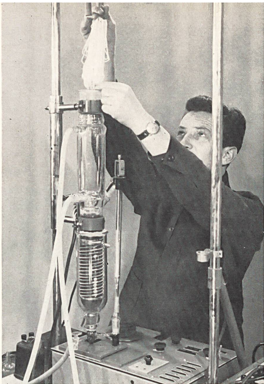
« Dyeometer » zur Bestimmung der Ausziehgeschwindigkeit von Farbstoffen im Färbebad.
