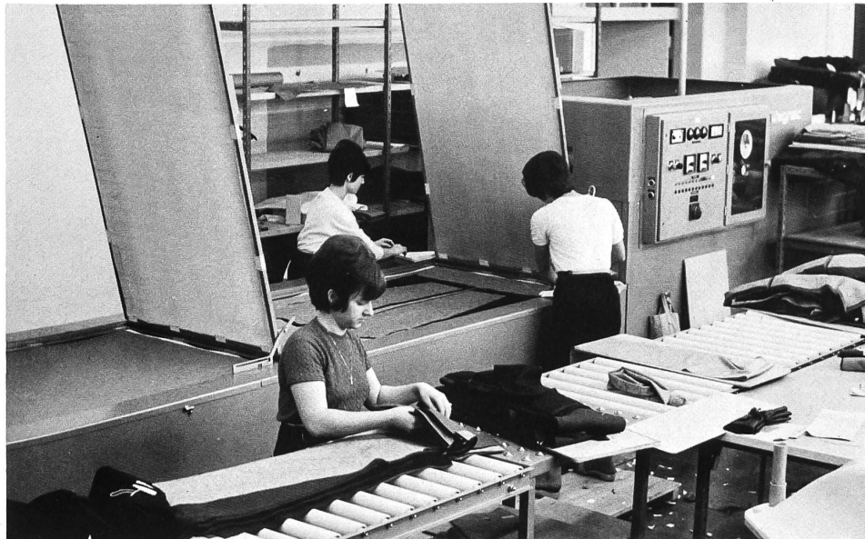
Vorderteilfixierung – Verkleben der Einlage mit dem Oberstoff
