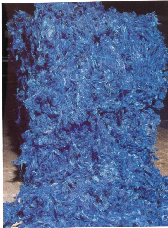
Fasermischung, bereit zur Speisung der Vlieskrempel
