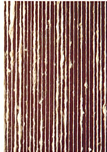
**Farbeneffekte:** Mélangegarn besteht aus verschiedenfarbigen Fasern. Vigoureux ist ein Kammgarn, bei welchem der melierte Farbton im Garn durch Bedrucken des Kammzuges erreicht wird. Jaspégarn ist ein Garn, welches das Aussehen eines aus zwei verschiedenfarbigen Garnen bestehenden Zwirnes hat.
