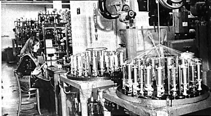
▷ Auf der Flechtmaschine werden Schleuderstäbe, aber auch dickere Kordeln überkloppelt / Sling bars as well as thicker cords are braided on the braiding machine.
