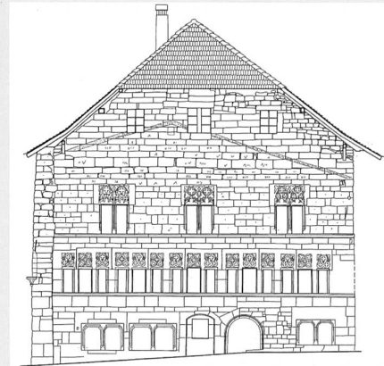
Élévation de la façade pignon sur rue avec trace d'un avant-toit la protégeant (SAEF 1997)
