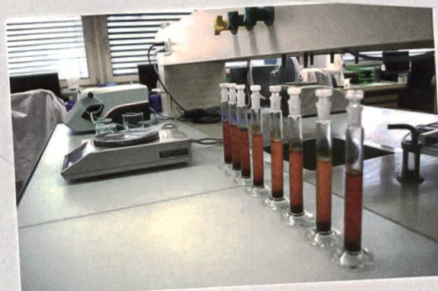
In den Reagenzgläsern wird der Swelling Index geprüft, also das Quellvermögen, hier vom A.Vogel Leinsamenprodukt.
