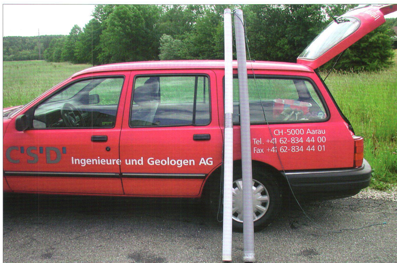
Fig. 2: Mit Zement verfüllte Plastikrohre für Slug-Tests in 4,5"-Piezometer. Links kleines Rohr ( \varnothing 6,3 cm), rechts grosses Rohr ( \varnothing 7,5 cm).
