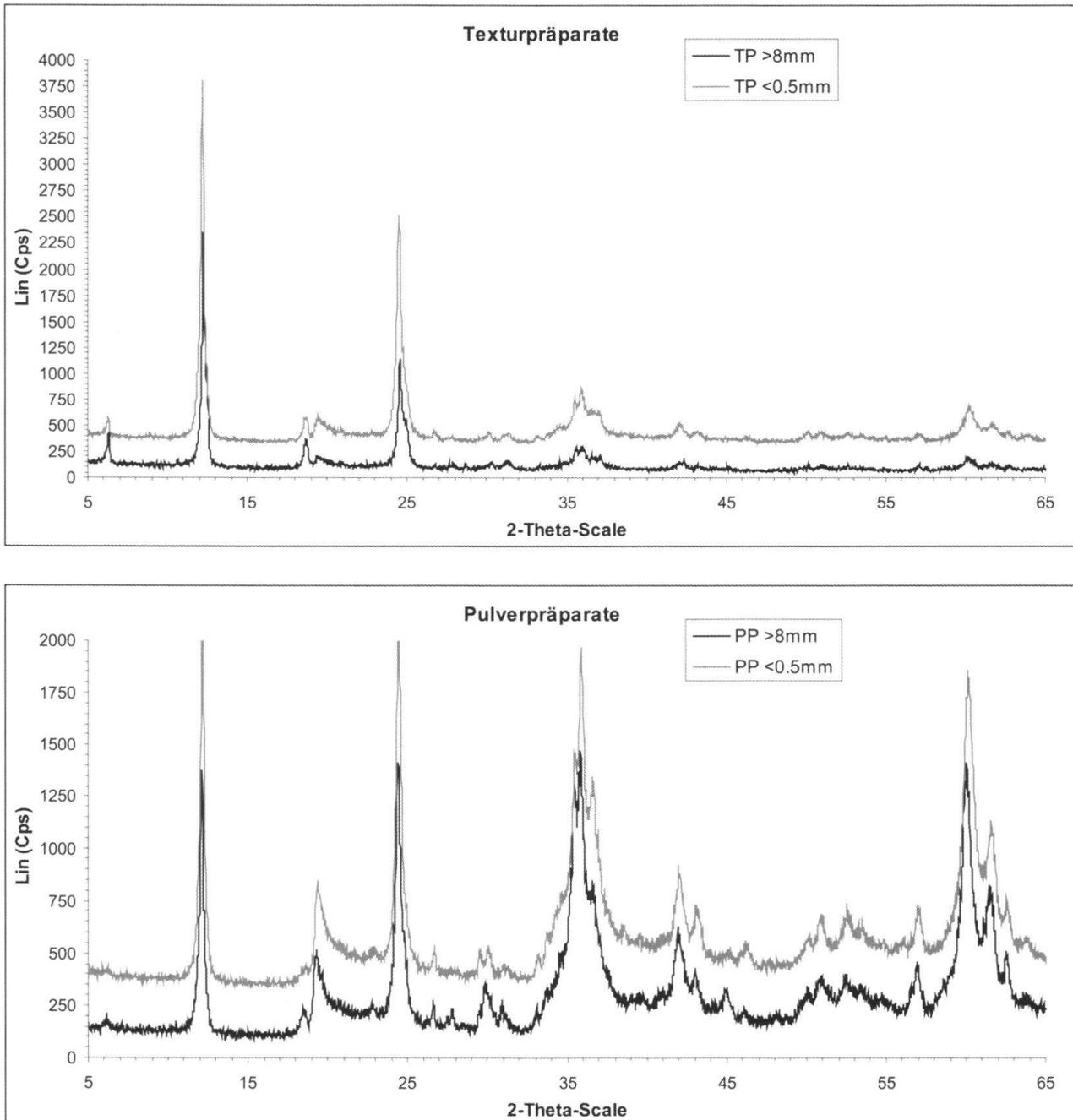
**Fig. 13:** Röntgendiffraktogramme der Textur- (oben) und Pulverpräparate (unten). Das Diffraktogramm der Kornfraktion <0.5mm (grau) ist leicht versetzt zum Diffraktogramm der Kornfraktion >8mm (schwarz) dargestellt. Die Diffraktogramme der Texturpräparate sind auf Antigorit normiert. Cu-Anode, Schrittweite 0,02° und Schrittzeit 3s.
