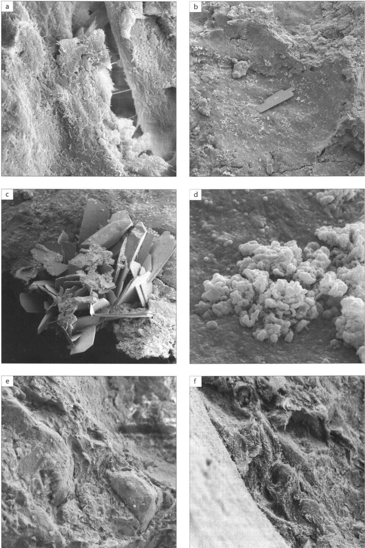
**Fig. 12:** Aufnahmen mit dem Rasterelektronenmikroskop. a: Grundmasse (Bildbreite 43  $\mu\text{m}$ ), b. Negativabdruck (Bildbreite 1744  $\mu\text{m}$ ), c: Idiomorphe Kristalle (Bildbreite 3792  $\mu\text{m}$ ), d: Blumenkohlartige Minerausscheidung (Bildbreite 55  $\mu\text{m}$ ), e: Deformierte Grundmasse zwischen zwei Körnern (Bildbreite 329  $\mu\text{m}$ ), f: Deformierte Grundmasse im Kontaktbereich eines Kornes (Bildbreite 22  $\mu\text{m}$ ).
