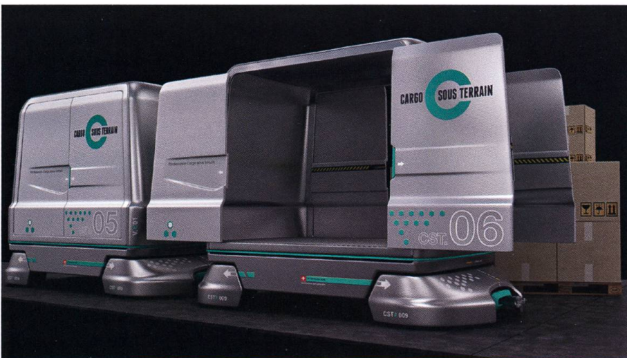
Fig. 4: Visualisierung der CST-Transportfahrzeuge mit Ladungsmodulen für 2 Europaletten.
