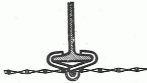
Abb. 6. Befestigung von Rauchs Reformrabitzen an eisernen T-Balken.
