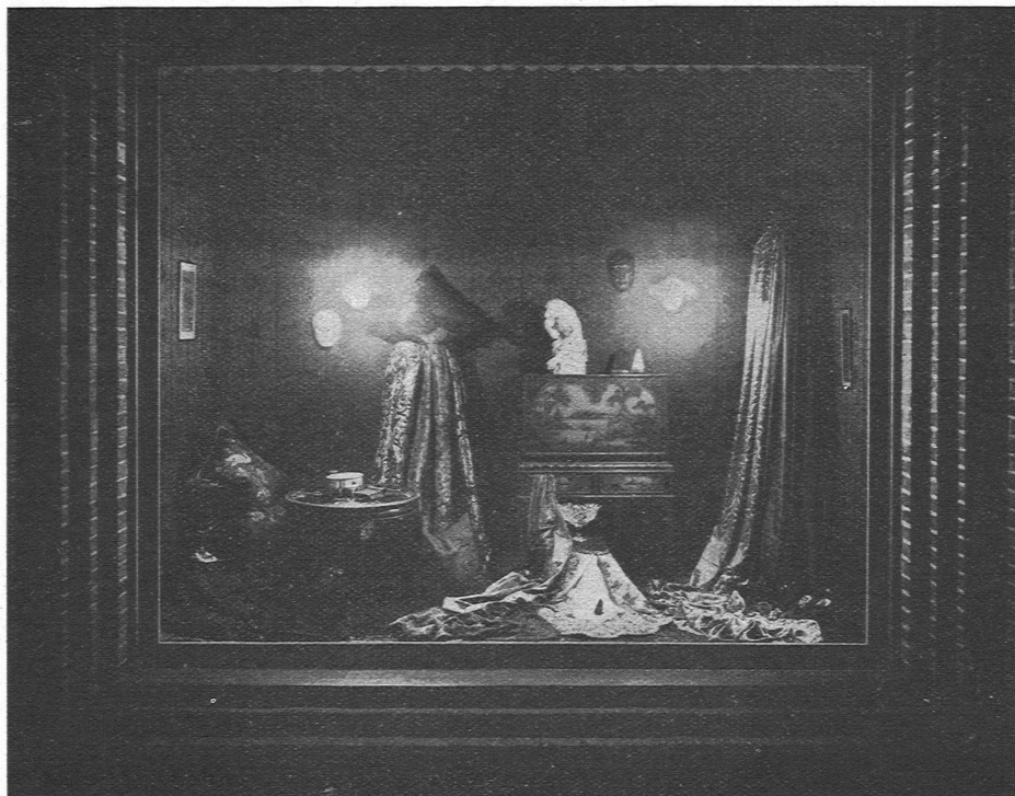
Abb. 1. Stark blendende Lichtquellen in Augenhöhe.
