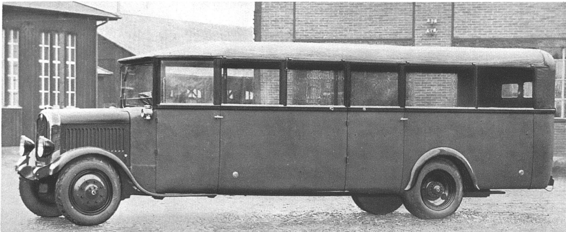
GESCHLOSSENER AUTOBUS / SAURER A. G., ARBON / Die äussere Gestalt des Wagens in völliger Uebereinstimmung mit seiner Aufgabe / Die Einfachheit, die durch Konstruktion und technische Notwendigkeit entstanden ist, wirkt elegant
