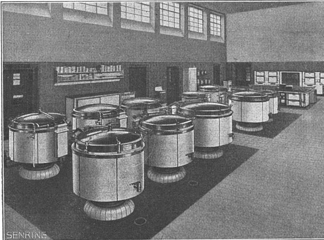
**Senking Ideal-Kochkessel und Kipptöpfe** aus nichtrostendem Stahl V2a. Innenkessel mit dem oberen Profiliring nahtlos aus einem Stück hergestellt. Vollkommen hygienisch.
