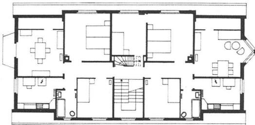
54 Dreizimmer- und 58 Vierzimmerwohnungen, total 112 Wohnungen in einem einfachen und 18 Doppelhäusern mit vollständig ausgebautem Dachgeschoss, wie dies vom veralteten Zürcher Baugesetz erzwungen wird. Gemeinsame Heizzentrale und Warmwasserversorgung. Infolge der durch die Bodenverhältnisse veranlassten verschiedenen Fundationen und Kellerhöhen variieren die Kubikmeterpreise zwischen Fr. 53.10 und Fr. 58.25. Kosten der Umgebungsarbeiten und Bepflanzung pro Wohnung ca. Fr. 1065.
