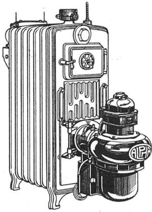
a Einphasemotor von 1/8 PS in Repulsions-Induktionsausführung, 125 oder event. 220 Volt, 50 Perioden
