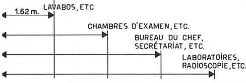
Der Einfluß der Wahl der Fensterachse für die Konstruktionslänge Gebäudes
