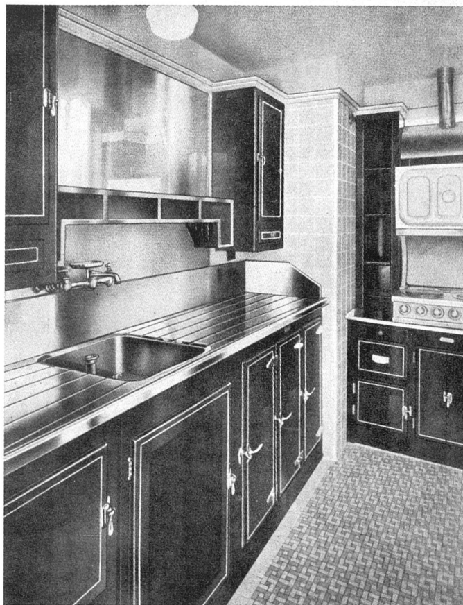
Abb. 8. Teilweise zusammenhängende Arbeitsflächen. Die schwarze Küche, 1930. Die Elemente sind noch weitgehend isolierte Möbel (aus Küchen Maid) / Surfaces de travail en partie continues. La cuisine noire, 1930. Les unités sont encore conçues par meubles isolés / Partially continuous working surfaces. The black kitchen, 1930. Units still treated as isolated pieces of furniture
