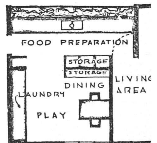
Abb. 19 und 19a. Küchen-Arbeitszentrum von George Nelson, 1944. Die großen Apparate (z. B. Herd) sind entsprechend dem fließenden Arbeitsvorgang in ihre Elemente zerlegt (aus Fortune Magazine) / Le centre de travail de la cuisine. Les différentes fonctions sont rassemblées d'une manière adéquate aux procédés rationnels de travail / Kitchen work center. The large units are broken down and reintegrated in a way suited to assembly-line production
