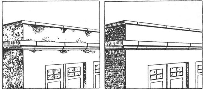
Fugen mit Zementmörtel:
