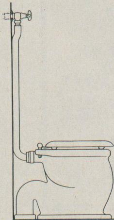
Der kurzgebaute **KWC**-Spülhahn soll bisherige Modelle mit unpraktisch großer Auskragung ersetzen.
