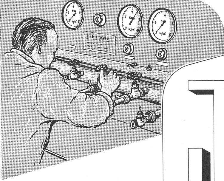
werden dann die zusammengesetzten Armaturen auf Dichtheit geprüft und einer peinlich genauen Funktionskontrolle unterzogen.
