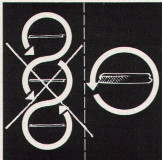
Die Mittellage des dreischichtigen Aufbaus besteht aus groben Spreißeln, wodurch sich eine kleine zu beleimende Fläche ergibt. Deshalb die einwandfreie, dauerhafte Verleimung jeder NOVOPAN-Platte!
