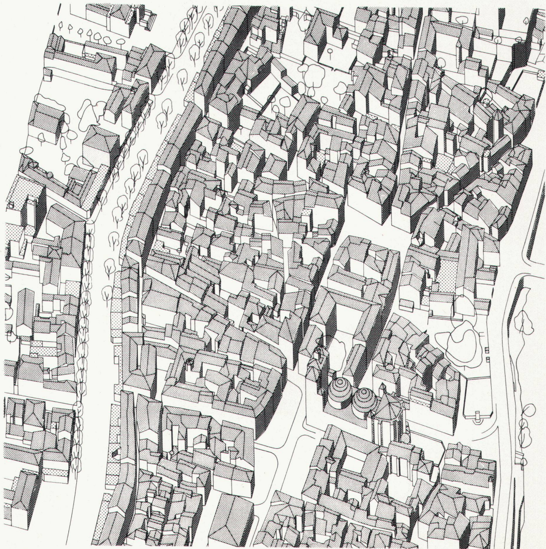
Fig. 18 Cahors. Relevé en vue axonométrique, par photogrammétrie aérienne. Echelle de l'original: 1:2000. Abb. 18 Cahors: Aufnahme aus axionometrischer Sicht durch Luftbildfotogrammetrie. Originalmassstab 1:2000.
