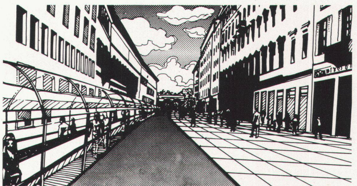
und für den Verkehr mit öffentlichen Transportmitteln (Krankenwagen, Taxi, Autobussen, Feuerwehrwagen u. a.), elektrisch angetriebenen Gütertransportwagen und Vehikeln für Invalide reserviert. Der rechte Strassenrand ist breiter als die anderen zwei Bereiche, ist autofrei, mit Platten belegt und erlaubt den Fussgängern eine bessere Bewegungsfreiheit.
