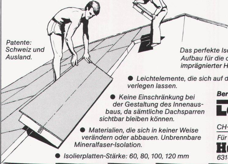
Das perfekte Isolier-System mit dem logischen Aufbau für die optimale Vollisolation. Mit überlappender, imprägnierter Hartfaserplatte.
