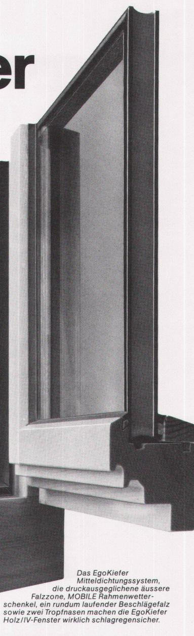
Das EgoKiefer Mitteldichtungssystem, die druckausgeglichen äussere Falzzone, MOBILE Rahmenwetzschelke, ein rundum laufender Beschlägefalz sowie zwei Tropfnasen machen die EgoKiefer Holz/IV-Fenster wirklich schlagregensicher.
