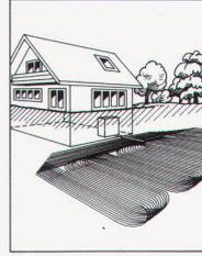
In einem Erdkollector (in 1 Meter Tiefe verlegte Kunststoffrohre) wird die mittels Sonnenkollektoren gesammelte Energie gespeichert.
