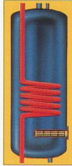
**Winterbetrieb:** Anschluss an den Heizkessel, da die Raumheizung sowieso läuft. Diese Ausnutzung der vorhandenen Kapazität macht die Energie für die Wassererwärmung extrem günstig.
