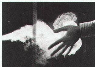
Je nach gewünschter Feuerwiderstandsklasse (F30 = 15 mm, F60 = 42 mm oder F90 = 50 und 74 mm) verhindert ein Brandschutzglas der F-Klasse, dass die Oberflächentemperatur auf der feuerabgekehrten Seite innerhalb von 30 bzw. 90 Minuten auf mehr als 140 Kelvin über Ausgangstemperatur ansteigt. Als Beispiel Daten eines Grossbrandversuches, den die Flachglas AG vor längerer Zeit unter Aufsicht der Berufsfuerwehr durchführte und der den Unterschied zwischen G- und F-Gläsern eindrucksvoll verdeutlicht:
