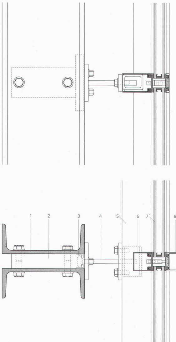
Horizontalschnitt Fassade: 1 C220,
