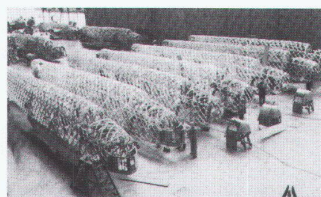
Abb. 11: Geodätische Strukturen der Wellington-Bomber, Vickers Factory, GB. Aus: Martin Bouwman: Wellington – The Geodetic Giant, 1989 (Seminar)
