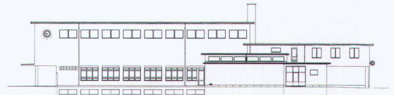
Ansicht des Saaltraktes, Hofseite mit den Metallschiebefenstern von 2002
