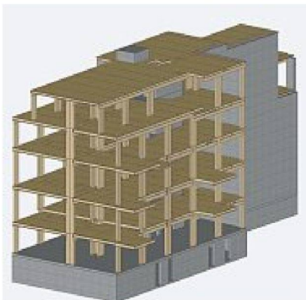
Axonometrisches Strukturmodell des Holzbausystems. – Bilder: Hector Egger Holzbau
