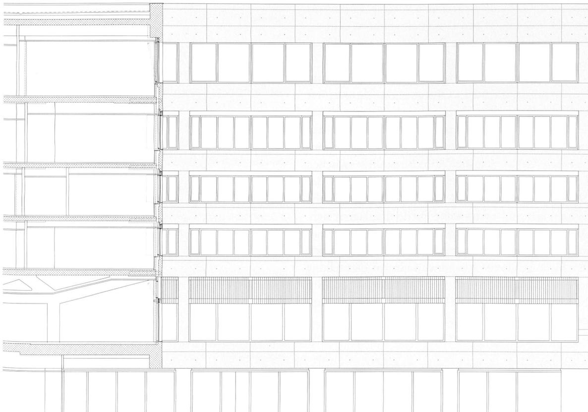
im Ausdruck des Tragens erzeugt. Statt einer Wand zeichnet hier ein gebündeltes Stabwerk die Bauform (vgl. wbw 6–2012). Voraussetzung für dieses Zusammenspiel zwischen kräftigen horizontalen und schlanken vertikalen Baugliedern ist die Kombination von Ortbeton und vorgefertigten Elementen, die vor Ort kraftschlüssig vergossen werden.
