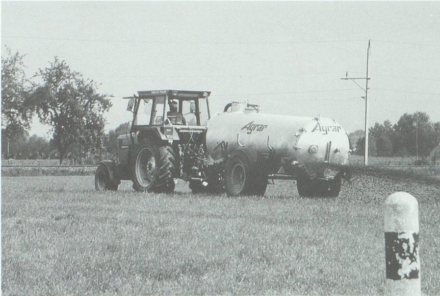
Abb. 4. Das neue Aufstallungssystem mit Schwenmentmistung bringt aus der Rindviehhaltung anstatt Mist und Harngülle nur noch Vollgülle. Mit dieser Rationalisierung veränderte sich auch die Gülleausbringtechnik. Zapfwellenbetriebene Druckfässer haben eine grosse Leistungsfähigkeit.
