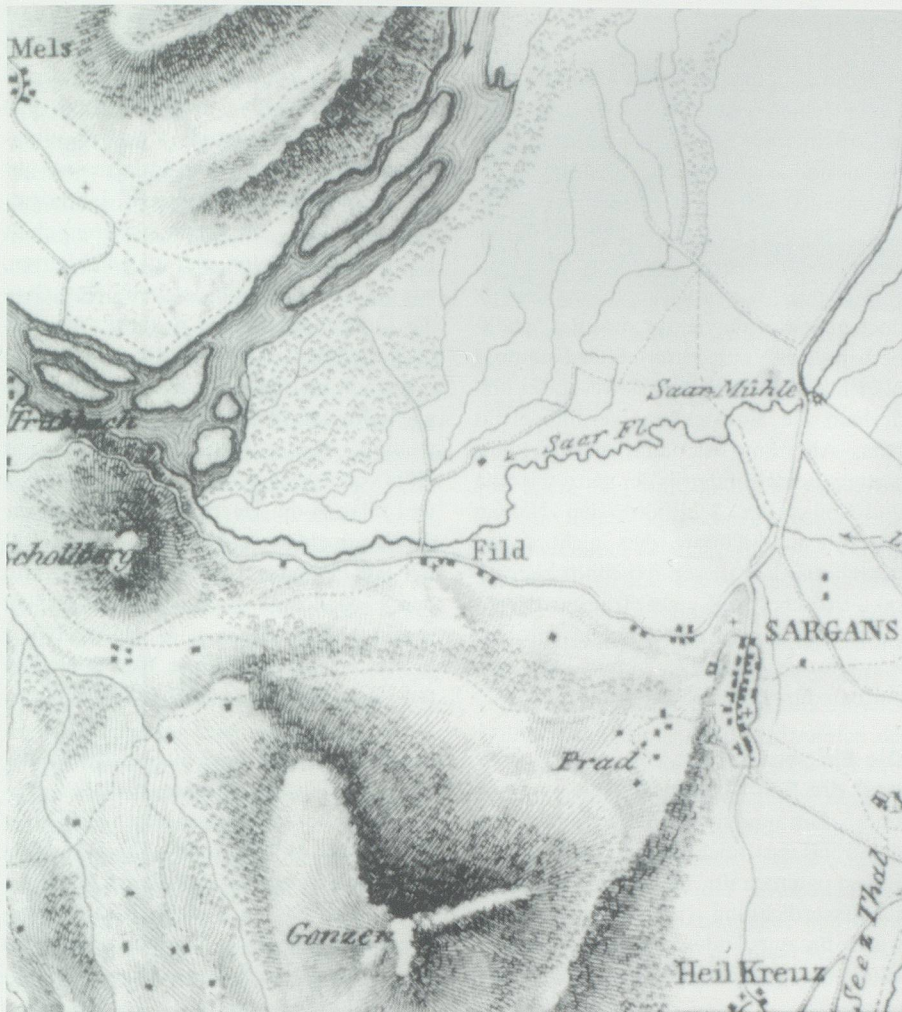
Auf alten Karten ist deutlich hervorgehoben, wie der Rhein in ständig wechselnden Verzweigungen am Schollberg seinen Lauf gegen Norden (links) änderte. Karte aus «Die Melioration der Saarebene», Mels 1978.
