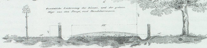
Abb. 21. Normal-Querprofile für Strassen erster (links) und zweiter Klasse (rechts). Aus dem Kreisschreiben vom 18. März 1834 zur Verordnung zur «Vollziehung des Gesetzes betr. die Uebernahme der Hauptstrassen von Seite des Staates».
