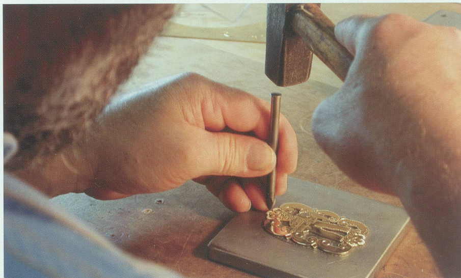
Beim Ziselieren, dem Ausschmücken der Messingteile mit spitzen Eisenwerkzeugen, ist viel Geduld nötig.
