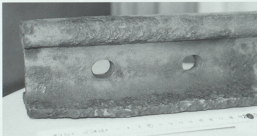
Abb. 8. Schienenende mit ovalen Löchern (Schiene 2).
