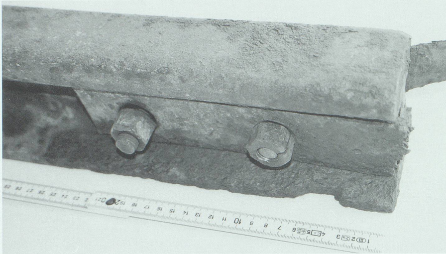
Abb. 7. Laschen und Laschenbolzen (Schiene 2).
