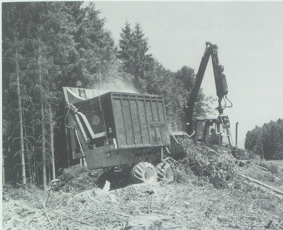
Ein zunehmender Anteil des Brennholzes wird heute – wie hier mittels Forwarder mit Aufbauhacker – direkt auf der Schlagfläche zu Holzhacksschnitzeln verarbeitet.
