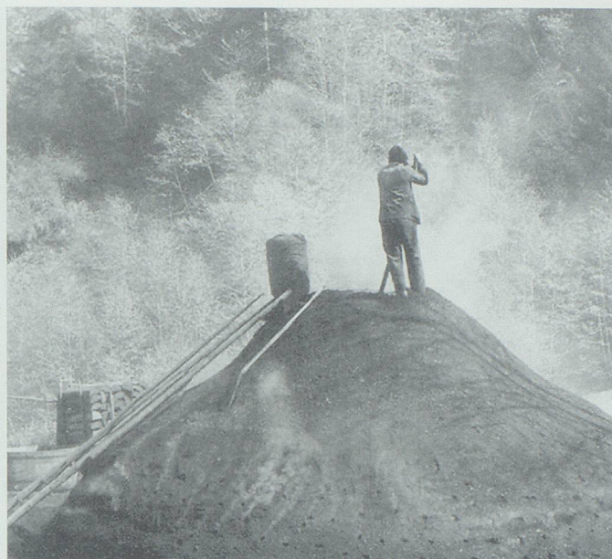
Die Verkohlung des Holzes ist gelungen – der Meiler ist eingesackt. Aus Gall 1/2003.
