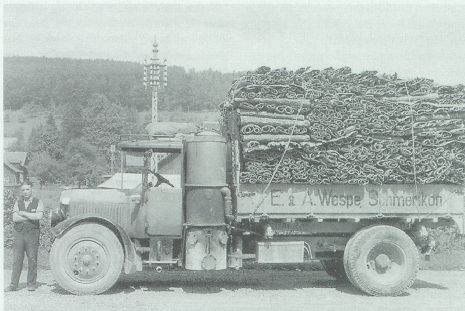
Rindenfuhrer für die Gerberei mit Holzvergaser-Lastwagen (um 1940). Aus Büttler 2003.
