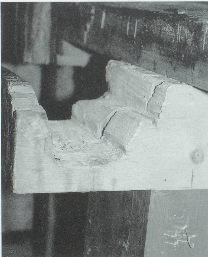
Im Schindelbock wird der Rohling bearbeitet.
