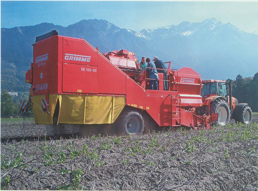
Moderne Ernte mit einem zweireihigen Kartoffelroder. Ausschuss wird bereits auf der Maschine aussortiert. Foto Peter Zogg, Weite
