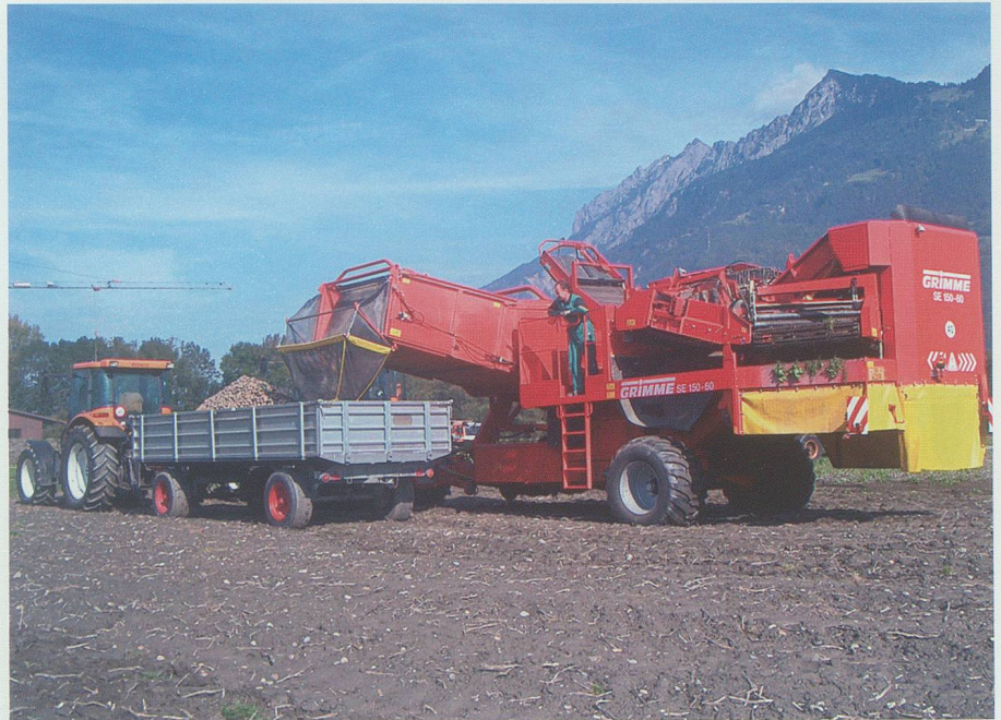
Von der zweireihigen Erntemaschine werden die Kartoffeln direkt in einen Kipper umgeladen. Foto Peter Zogg, Weite
