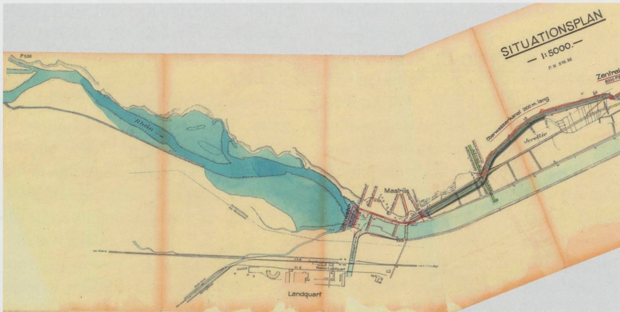
Das Stauwehr unmittelbar oberhalb der Einmündung der Landquart in den Rhein mit dem Einlauf in den Kanal. Ausschnitt aus dem Situationsplan. Plan in den Akten SAK im StASG
